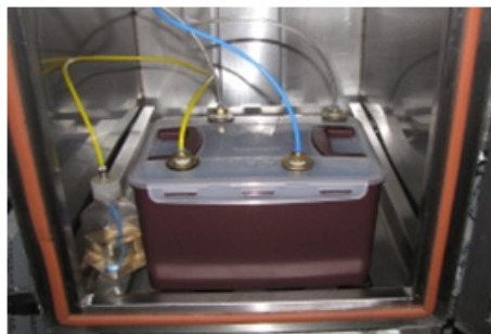
<그림 3> 호흡량 측정용 밀폐용기
