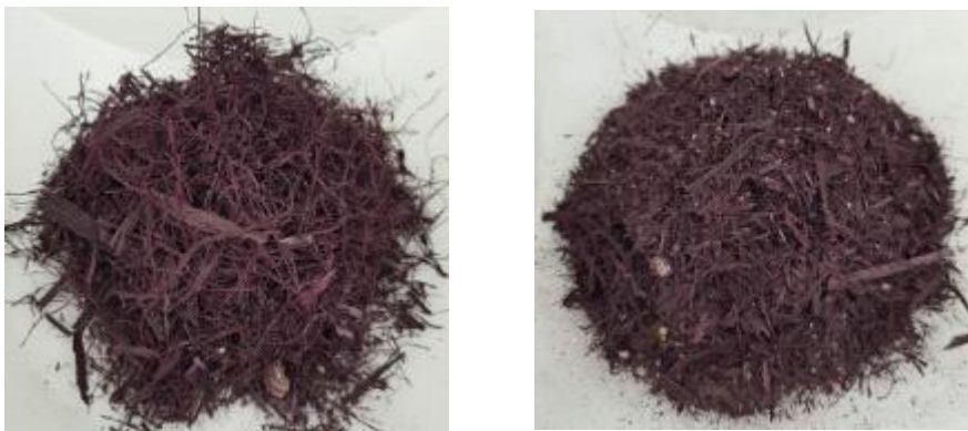
그림 4. 건조온도별 분쇄 시료 (좌)30°C, (우)50°C
